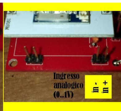
L'ingresso analogico accetta solo tensioni tra 0 ed 1V! Se dovete misurare tensioni superiori usate un partitore resistivo. ATTENZIONE: su questo ingresso non c'è protezione!
